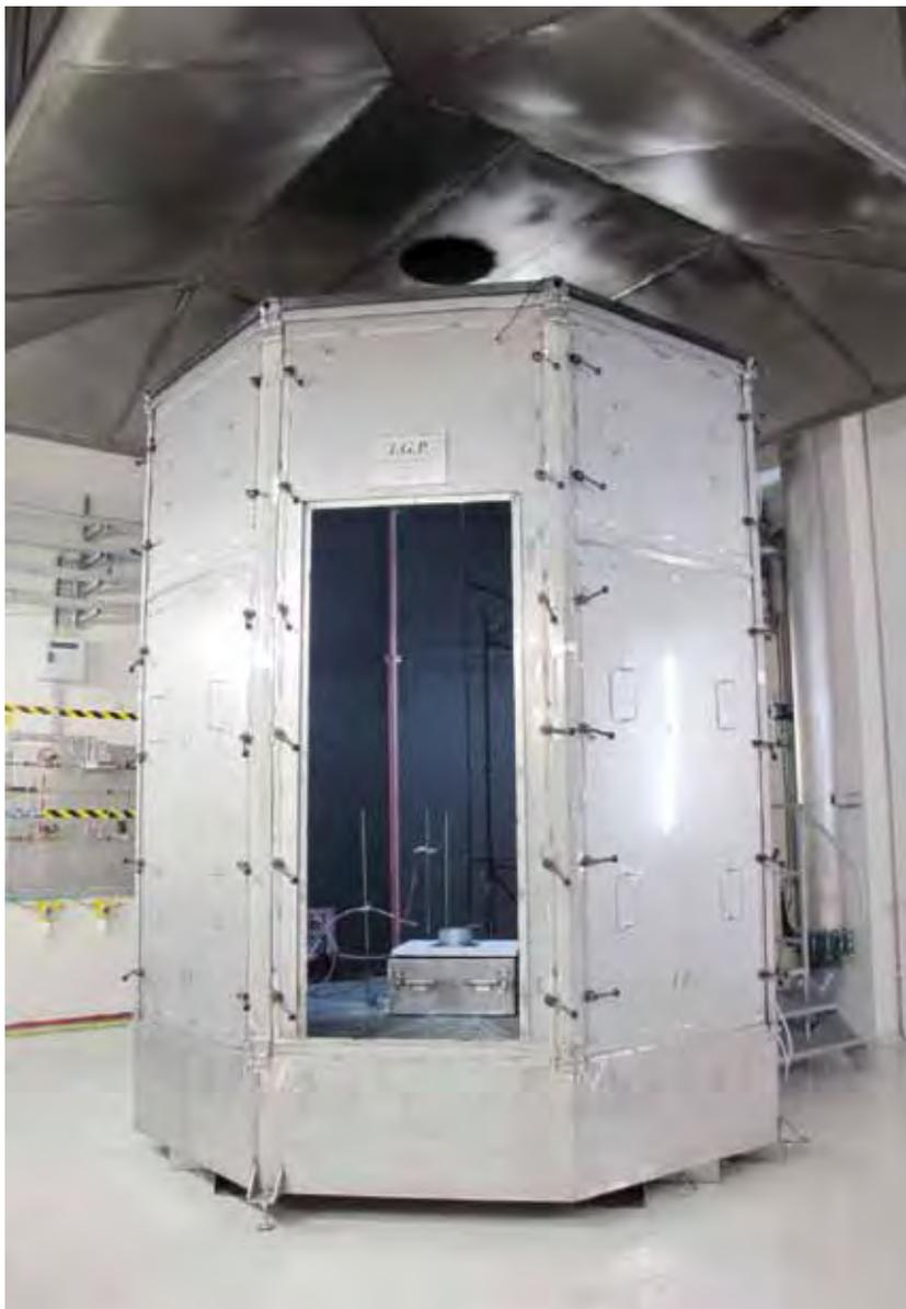
Figure 1. Calorimètre à atmosphère contrôlée: CADUCEE
