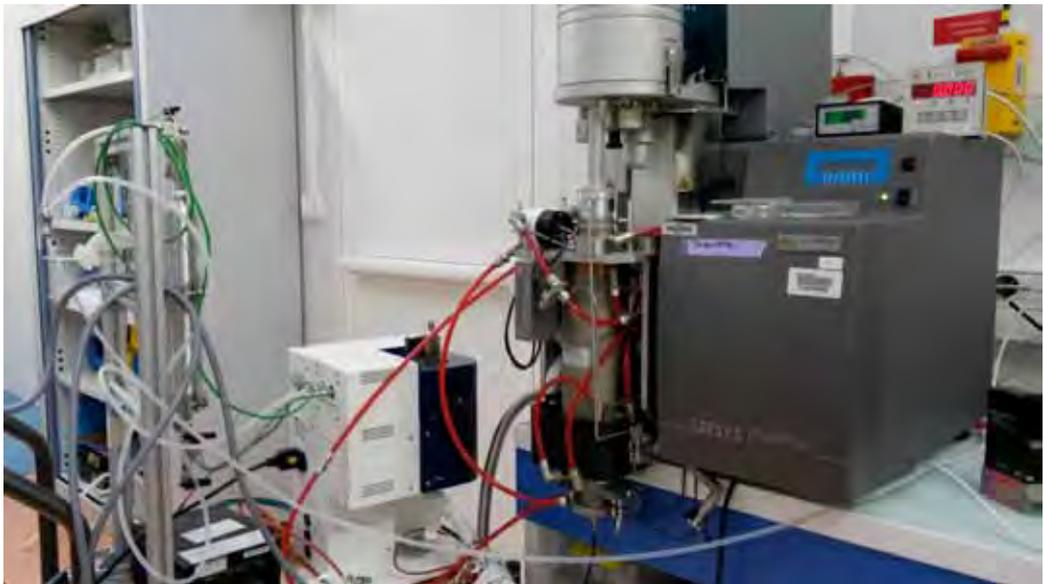
*Figure 1. Appareil d'analyse thermogravimétrique (droite)
